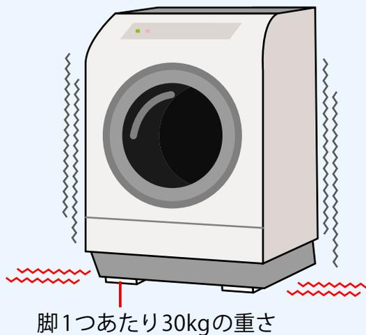
このとき、適正荷重が30kgのゲルダンパーを各脚に設置すれば、床に伝わる振動を防ぐことができます！
